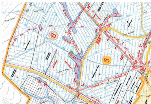
Extrait du plan d'enquête des travaux de drainages et nouveaux collecteurs, SAF Engollon, 2013
